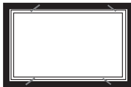
SNEDSTÄLLDA SKRUVAR MELLAN KARM OCH FÖNSTER
