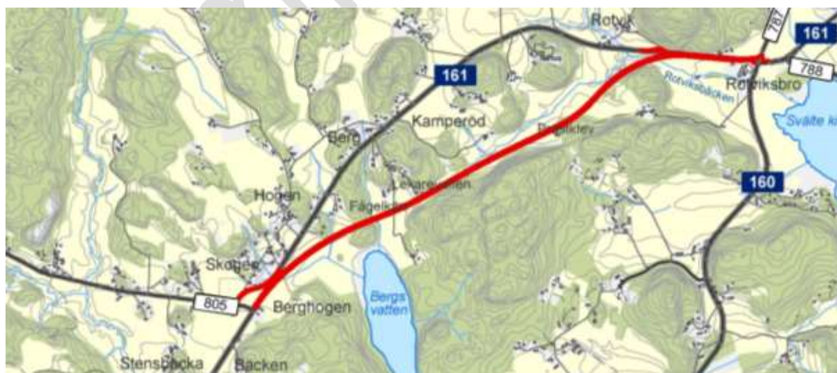
Figur 1. Bild ur vägplanen för delsträckan Rotviksbro-Bäckan, där rött anger den föreslagna vägsträckningen.
